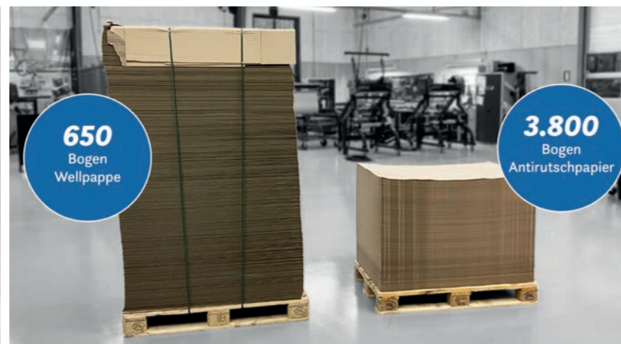
Ein Produkt, das unter anderem auf der ProSweets Cologne viel Aufmerksamkeit erregte, ist das Antirutschpapier Antim. Das extrem dünne Papier hält Packgüter auf der Palette bis zu einem Neigungswinkel von 50° sicher in Position und reduziert gleichzeitig den Verbrauch von Stretchfolie bei der Umwicklung. Zudem ist die Lösung günstiger im Vergleich zu den klassischen Wellpappzwischenlagen. (Fotos: Knüppel Verpackung)
