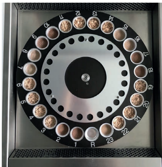
Proben verschiedener Schokoladenmassen und Produktionsstufen von Milkschokoladen im Sorptionsprüfsystem SPS zur Ermittlung des Gehalts an amorpher Lactose.
